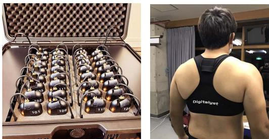
図2 デジタルリスト Type-S, GNSS用ベスト
